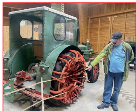
Schlepper mit Schneeketten und erste Traktoren mit Gummibereifung
